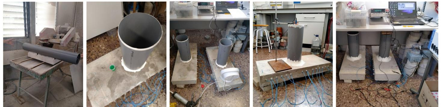
Imagen 2. Instalación del depósito sobre las losas y toma de datos. / Image 2. Ponding installation on reinforced concrete slabs and analysis.
