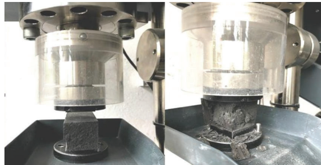
Figure 5. The specimen during the compressive strength test. Left – before starting the test, right – after failure of the specimen Rysunek 5. Próbkę podczas testu wytrzymałości na ściskanie. Po lewej - przed rozpoczęciem badania, po prawej - po zniszczeniu próbki
