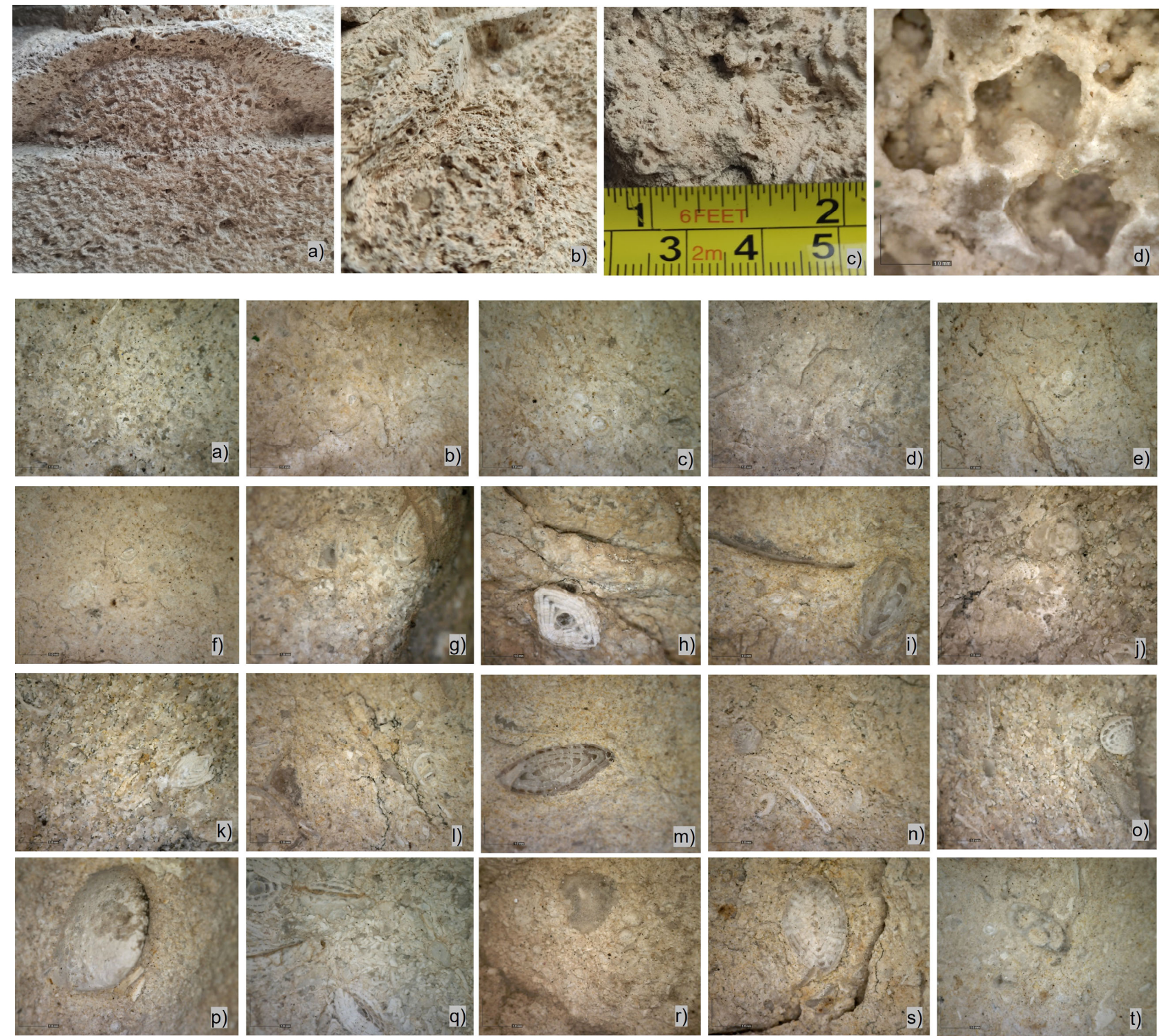
Figura 4 (a-t). Caliza de Girona blanca, detalles de la textura pétreas vistas al microscopio Digital USB DinoLite AM4113T. a) Base 1, Arco 1; b) Base 2, Arco 3; c) Base 2, Arco 4; d) Base 3, Arco 1; e) Base 3, Arco 3; f) Capitel 1, Arco 3; g) Capitel 1, Arco 4; h) Capitel 1, Arco 6; i) Capitel 2, Arco 2; j) Capitel 2, Arco 2; k) Capitel 2, Arco 4; l) Capitel 2, Arco 6; m) Capitel 3, Arco 2; n) Capitel 3, Arco 3; o) Capitel 3, Arco 4; p) Capitel 3, Arco 6; q) Capitel 4, Arco 3; r) Capitel 4, Arco 4; s) Capitel 4, Arco 6; t) Capitel 5, Arco 5. Figure 4 (a-t). White Girona limestone, details of the stone texture seen under the DinoLite AM4113T USB Digital Microscope. a) Base 1, Arch 1; b) Base 2, Arch 3; c) Base 2, Arch 4; d) Base 3, Arch 1; e) Base 3, Arch 3; f) Capital 1, Arch 3; g) Capital 1, Arch 4; h) Capital 1, Arch 6; i) Capital 2, Arch 2; j) Capital 2, Arch 2; k) Capital 2, Arch 4; l) Capital 2, Arch 6; m) Capital 3, Arch 2; n) Capital 3, Arch 3; o) Capital 3, Arch 4; p) Capital 3, Arch 6; q) Capital 4, Arch 3; r) Capital 4, Arch 4; s) Capital 4, Arch 6; t) Capital 5, Arch 5.
