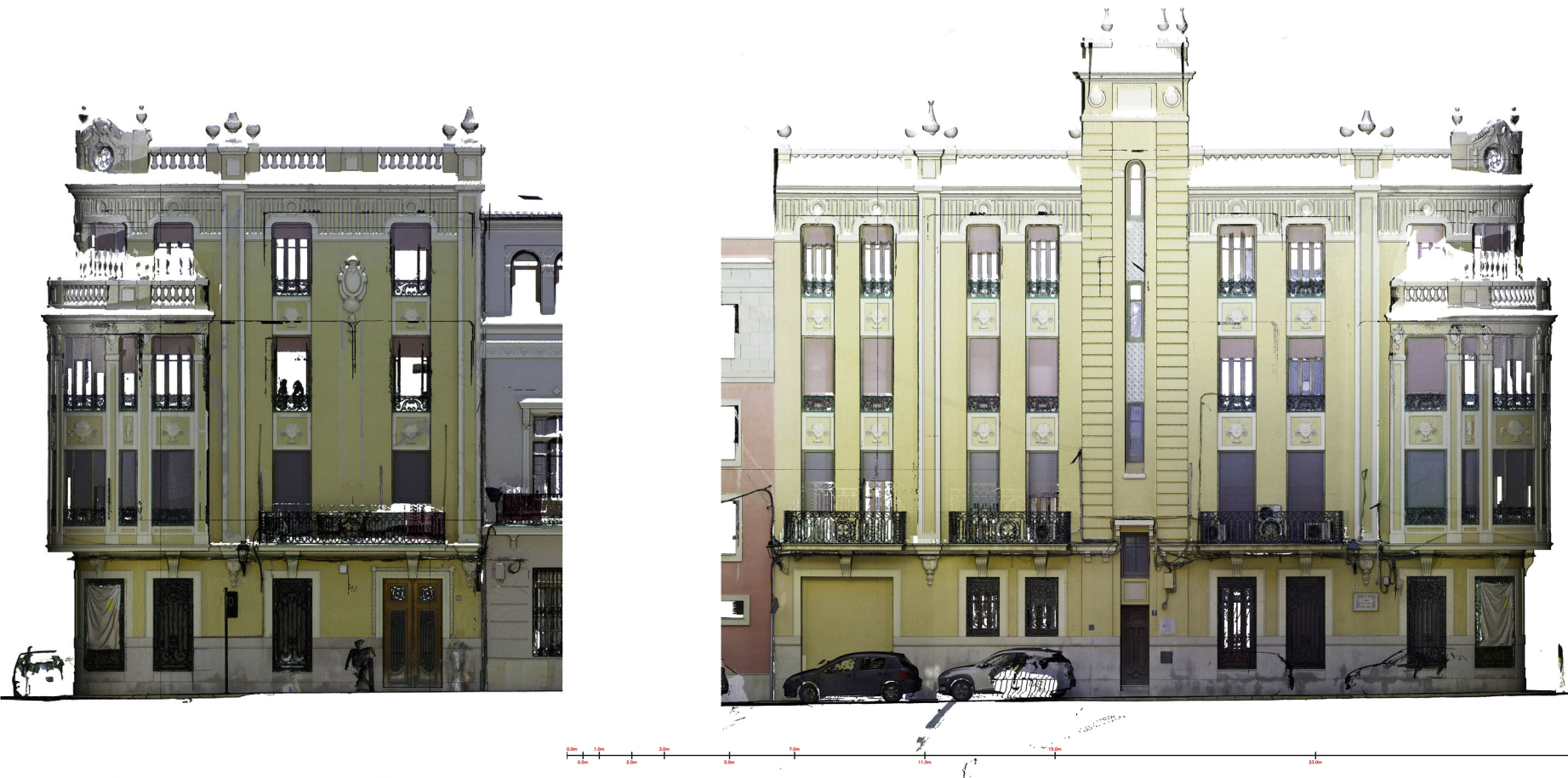
Imagen 8. Levantamiento de las fachadas con escaner láser 3d (TLS). Image 8. Surveying of the facades with 3D laser scanning (TLS).
