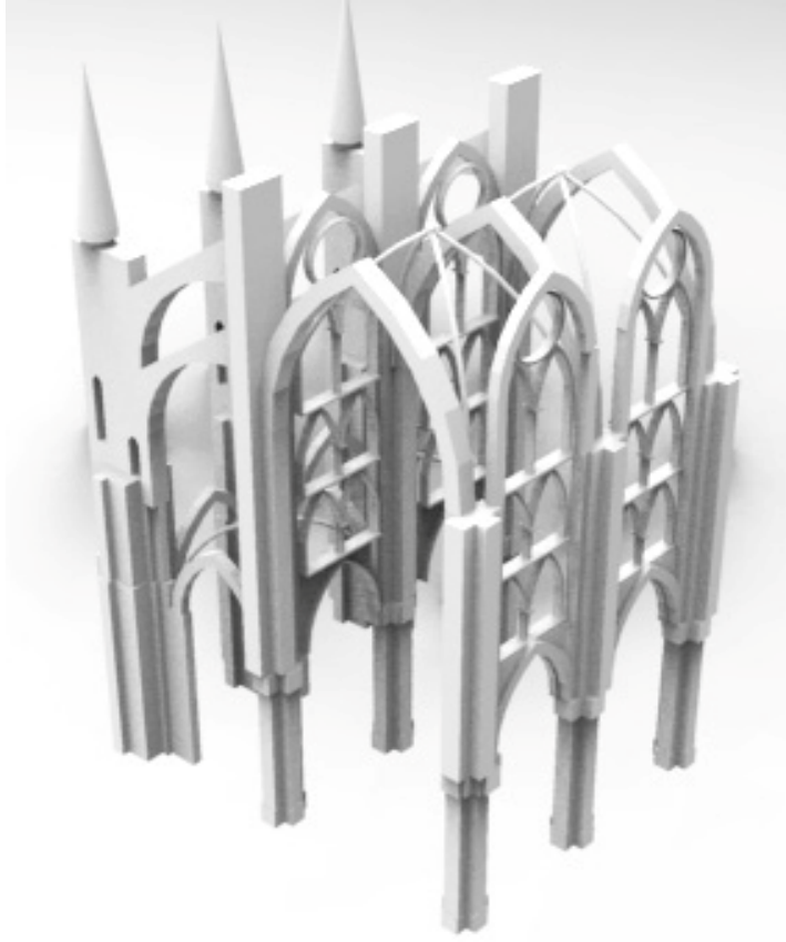
Imagen 2. Esquema estructural del gótico Centroeuropeo Image 2. Central European Gothic structural outline
