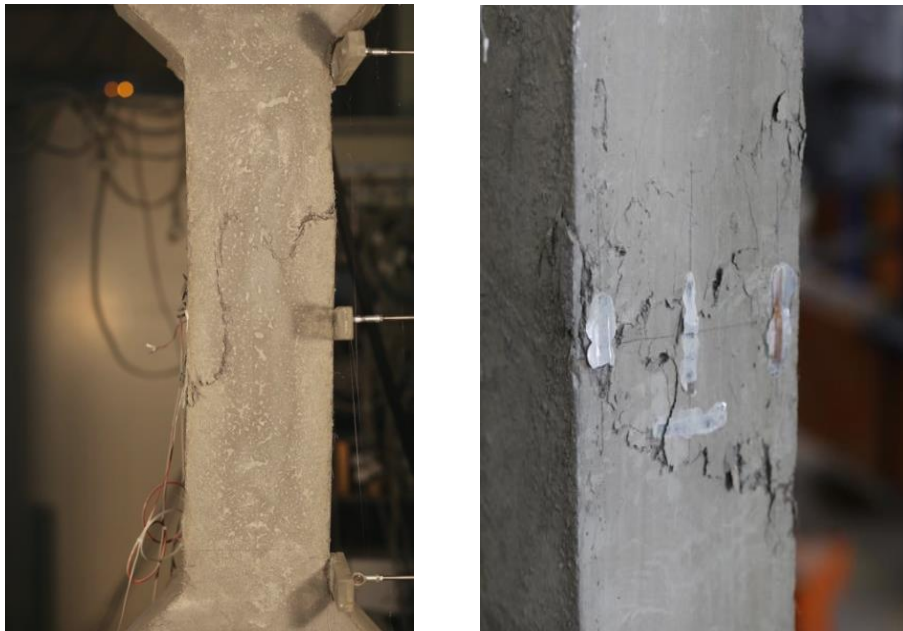
Figura 2: Izquierda: Vista frontal de un espécimen ensayado; derecha: Estado de la cara comprimida tras el ensayo.
